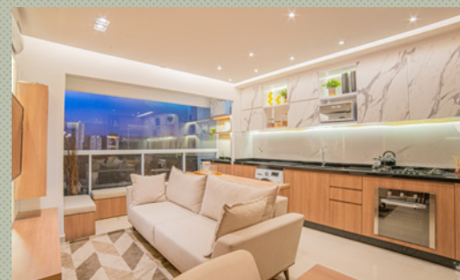
Paredes da cozinha e área de serviço totalmente revestidas com cerâmica 30x60.
